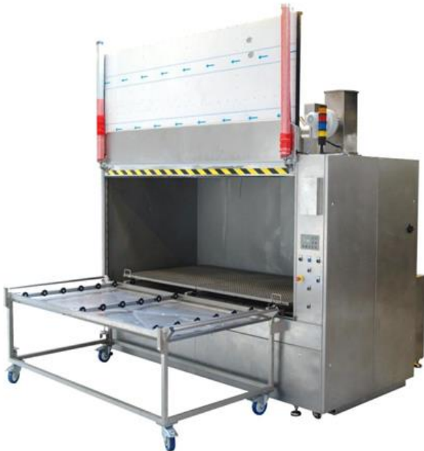
Automatisk tvättmaskin för produktionsutrustning hos IKEA. Älmhult
