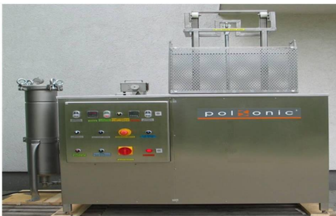
Bilden visar en ultraljudsvätt med inbyggd rening och automatisk korglyft.
